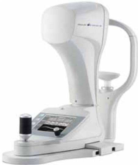
Das neue Corvis® ST ist eine Hochgeschwindigkeits-Scheimpflugkamera, die in Verbindung mit einem Non-Contact Tonometer die Veränderungen der Hornhaut auf den Luftimpuls visualisiert. Nach der Messung kann der Betrachter die Highspeed-Filmsequenz (über 4.000 Bilder/sec) in slow-motion betrachten und so die Bewegung der Cornea genau verfolgen.
