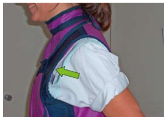
Abb. 3 Durch den zu großen Armausschnitt kann seitlich Strahlung eintreten. Es sollten hier zusätzlich Schulterabdeckungen (Epauletten) Verwendung finden (Foto Dr. H. Krieger)
