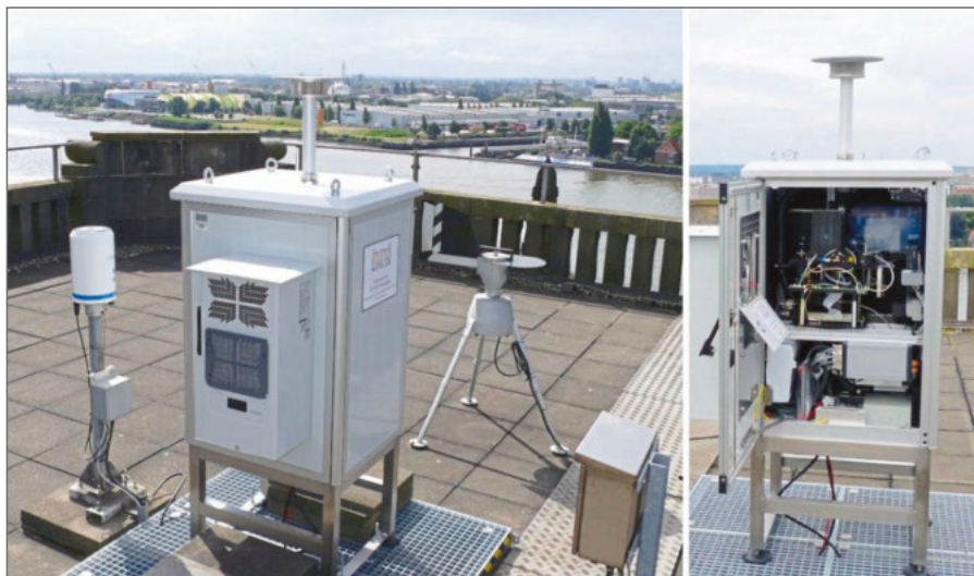
Abbildung 2 und 3: Der automatische Pollenmonitor des DWD auf dem Turm des Seewetteramtes in Hamburg (Quelle: Deutscher Wetterdienst)
